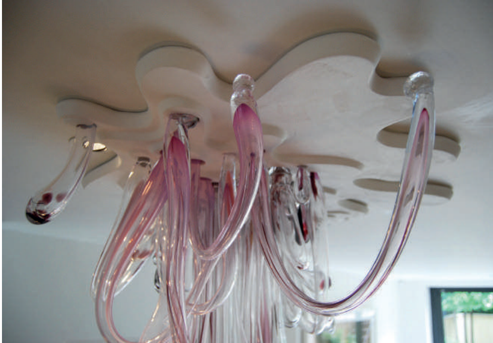
Toutes les pièces en verre sont aimantées et pluggables / dépluggables dans la structure en bois et métal.
